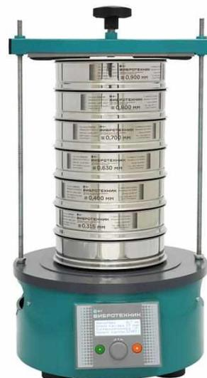
Рис. 2 Анализатор А 20 на базе Вибропривода ВПС
